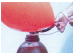
6 Ballon mit Hilfe des Schnellverschlusses verschließen
