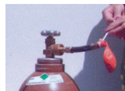
4 Schnellverschluss und Ballon über das Ballongasventil ziehen
