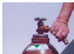
8 Ballongasventil nochmals abwinkeln, damit Restgas entweichen kann
