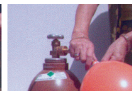
5 Ballongasventil abwinkeln, damit Gas in den Ballon strömt
