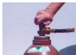
3 Handrad vom Flaschen-Absperrventil öffnen
